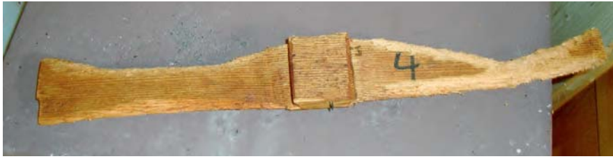
Aus den Holzfasern von diesem beschädigten Keil ...
